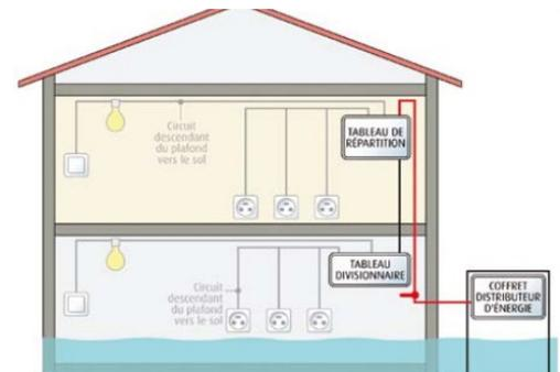
Principe de séparation des installations électriques situés au-dessus et en dessous du niveau des PITEC
